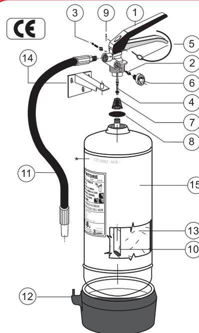
\*\* Marchiatura serbatoio: (Ente di Sorveglianza) CE 1370, produttore serbatoio, decimale anno produzione, (Codice identificativo produttore) 0095, n° matricola serbatoio, (Pressione di collaudo) PT xx Bar.
